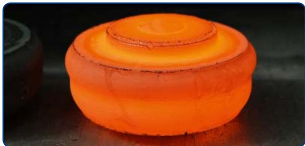
Защитные технологические покрытия обеспечивают защиту от окисления, обезуглероживания, выгорания легирующих элементов, газонасыщения поверхности деталей и заготовок различной конфигурации и габарита из высоко- и среднелегированных сталей, коррозионностойких, штамповых сталей, жаропрочных никелевых, титановых, интерметаллидных, бериллиевых, ниобиевых, циркониевых, тугоплавких сплавов при термической обработке и нагревах под горячую деформацию.
