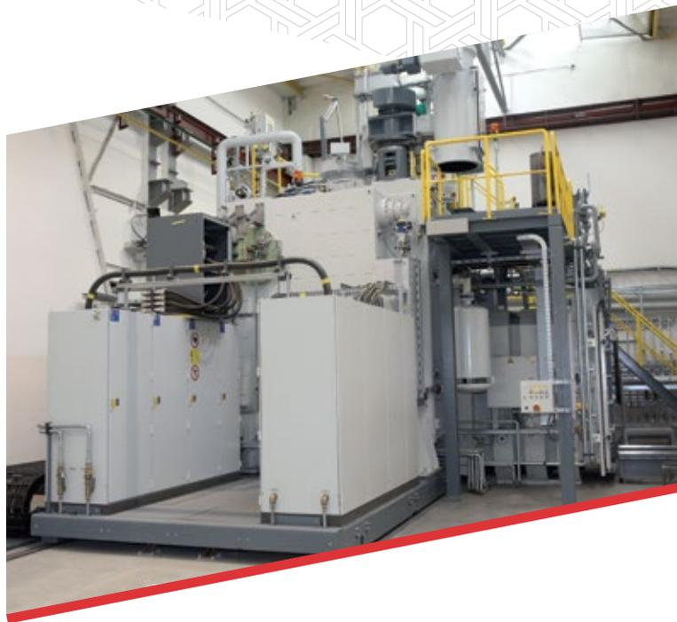
На современном вакуумном плавильном оборудовании – вакуумные индукционные печи VIM12 (тигли емкостью 15 и 30 кг), VIM50 (тигель емкостью 350 кг) и VIM150 (тигли емкостью 650 и 1000 кг) – выпускают заготовки из сложнелегированных высокожаропрочных сплавов на основе никеля: ЖС6У-ВИ, ЖС6К-ВИ, ЖС16-ВИ, ЖС26-ВИ, ЖС32-ВИ, ЖС36-ВИ, ВЖЛ12У-ВИ, ВЖЛ21-ВИ, ВЖЛ12Э-ВИ, ВХ4Л-ВИ, ЖСЗДК-ВИ, ВЖМ1-ВИ, ВЖМ4-ВИ, ВЖМ5-ВИ, ВЖМ6-ВИ, ВЖМ7-ВИ, ВКНА-1В, ВКНА-1ВР, ВКНА-4У, ВКНА-25, ЖСКС1-ВИ, ЖСКС2-ВИ и других сплавов.
