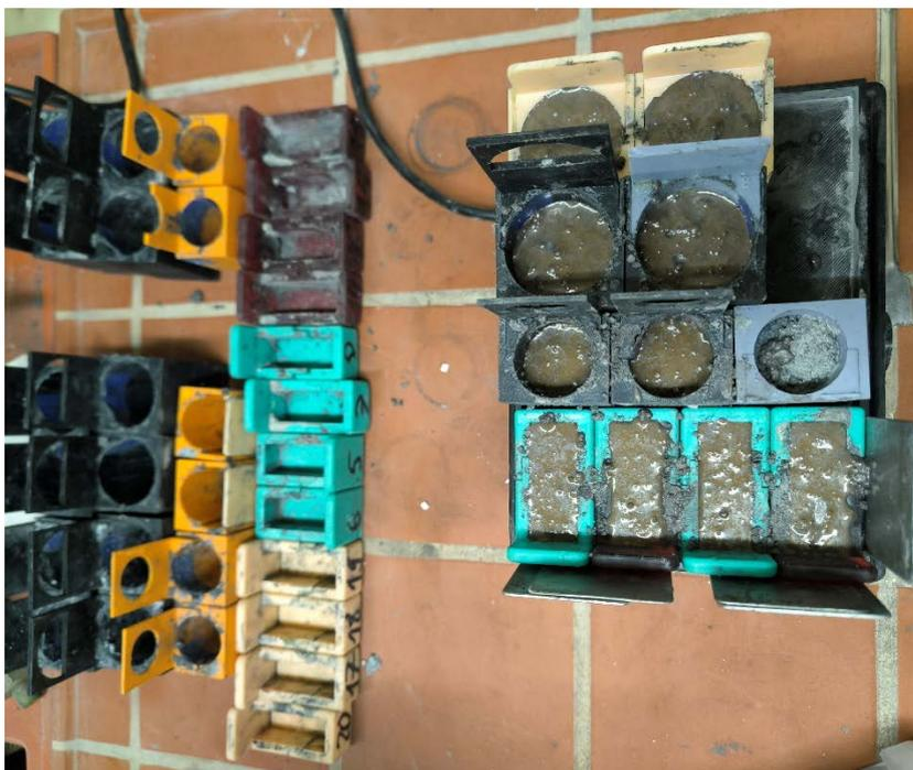
Рис.4. Формование образцов на вибростоле при минимальной влажности
