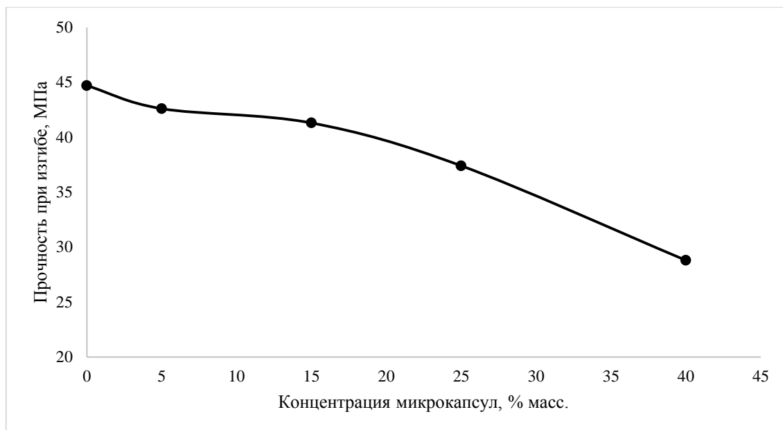
Рис. 5 – Зависимость прочности при изгибе от содержания капсул в связующем
