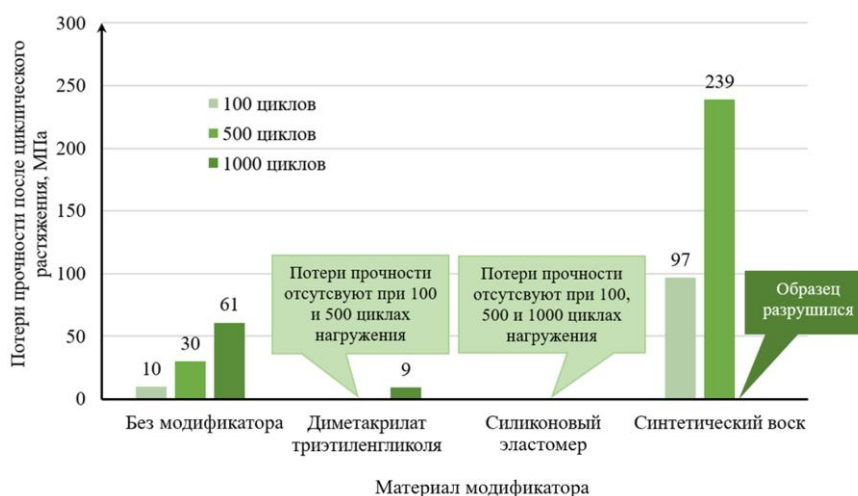
Рис. 3 – Потери прочности после циклического растяжения ПКМ с направленной релаксацией напряжений при деформировании при использовании модификаторов различной химической природы
