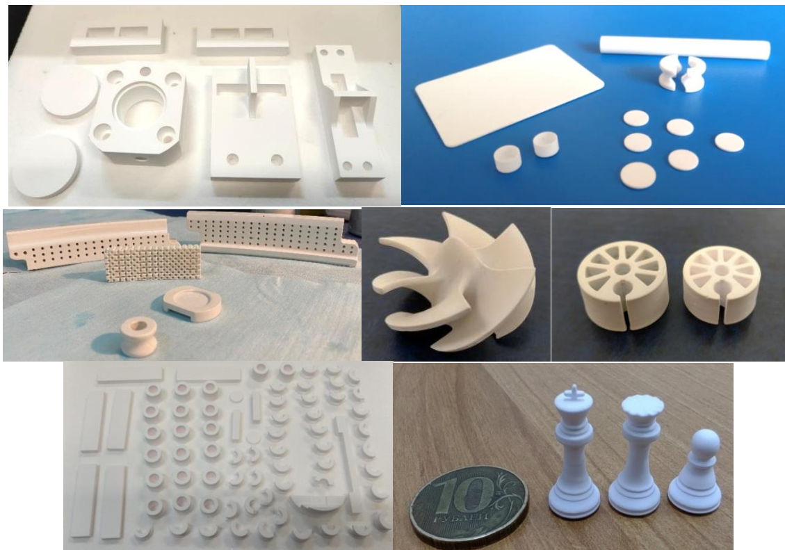
Рис. 15. Примеры изделий из оксида алюминия, полученных методами SLA и DLP из высоконаполненной фотоотверждаемой керамической композиций разработки НИЦ «Курчатовский институт - ВИАМ»
