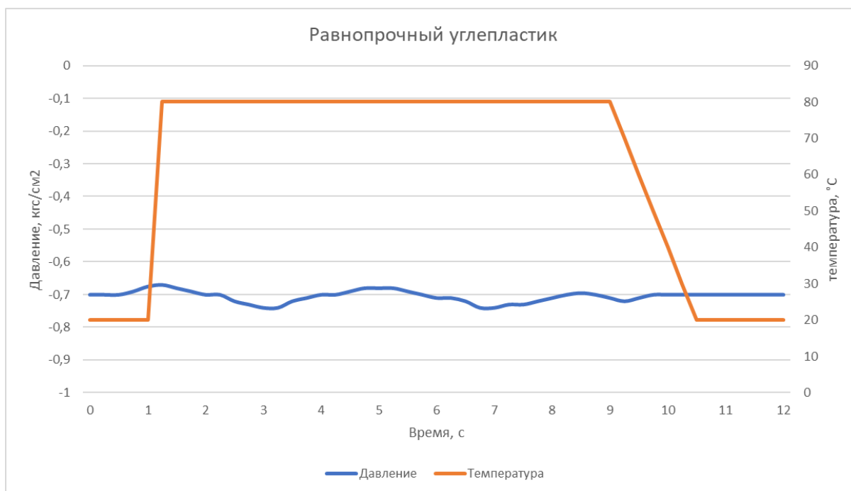
Рисунок 3 – графики уровней разрежения и температуры от времени для равнопрочного углепластика
