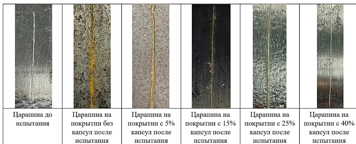
Рис. 6 – Результаты испытаний на коррозионную стойкость
