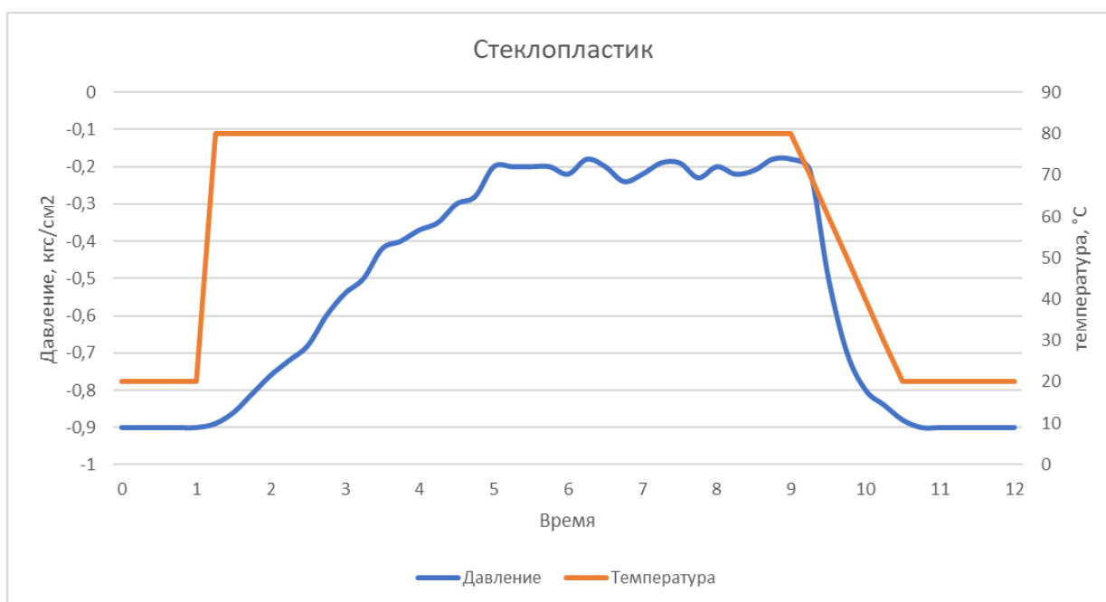
Рисунок 5 – графики уровней разрезания и температуры от времени для стеклопластика
