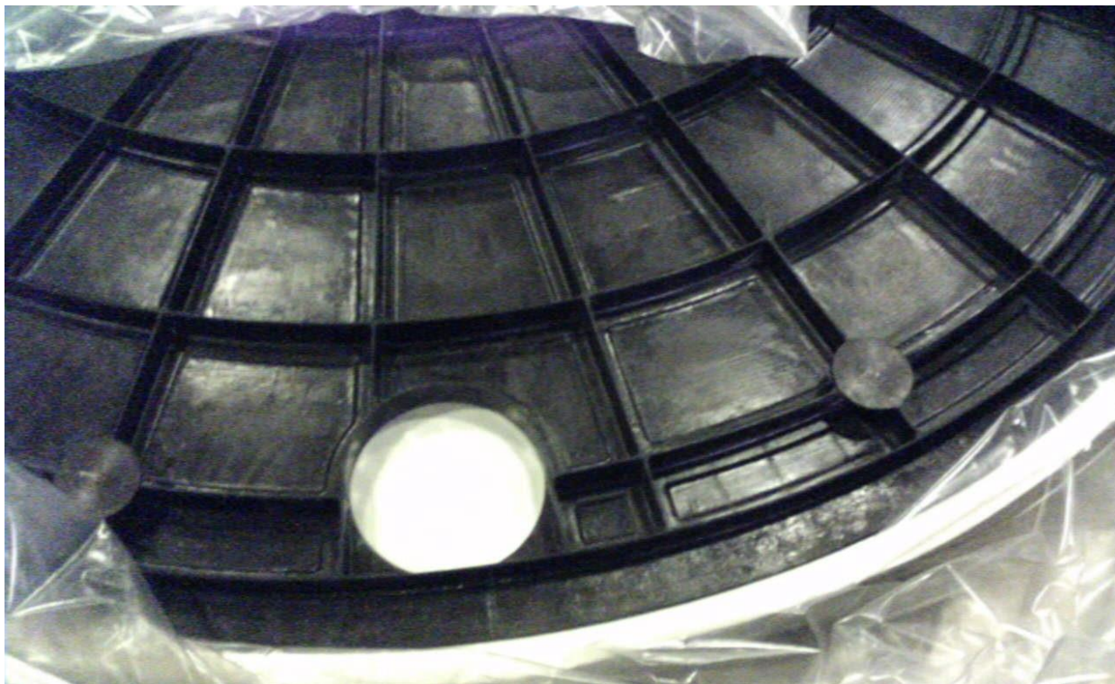
Рис. 1 – Фрагмент размеростабильной углепластиковой интегральной конструкции центрального зеркала диаметром 2,6 м радиотелескопа «Спектр-Р»
