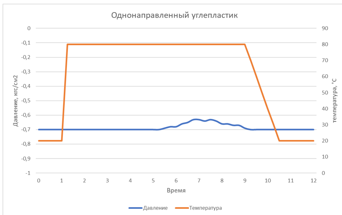
Рисунок 4 – графики уровней разрезания и температуры от времени для одностороннего углепластика
