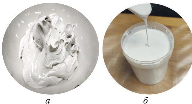
Рис. 7. Высоконаполненные фотоотверждаемые керамические композиции на основе оксида алюминия: (а) - паста с содержанием 85 масс. % Al_2O_3 , (б) - суспензия с содержанием 80 масс. % Al_2O_3
