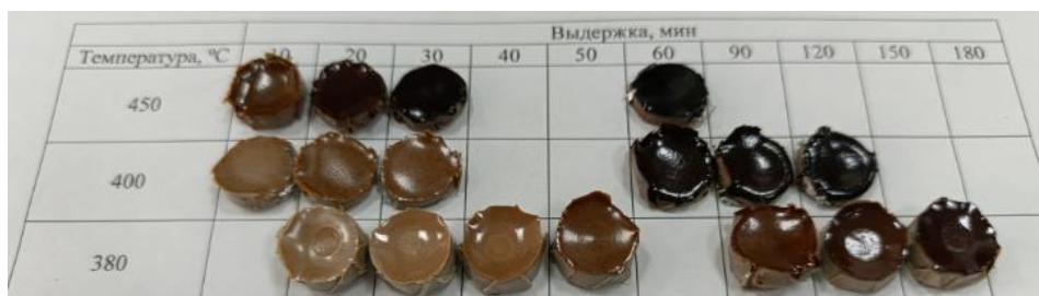
Рис. 9 Изменение цвета образцов ПЭЭК при высокотемпературной термообработке.
